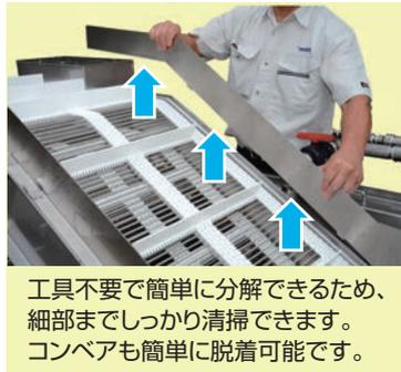
工具不要で簡単に分解できるため、細部までしっかり清掃できます。コンベアも簡単に脱着可能です。
