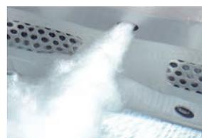
洗浄槽の両側面に配置されたエジェクタからジグザグに噴射。低圧噴射された水流と泡が食品をやさしく「もみ洗い」します。
