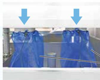
ネットは循環経路に2個取り付けられているため、作業を止めることなく、ネットの交換と異物の回収が交互にできます。
